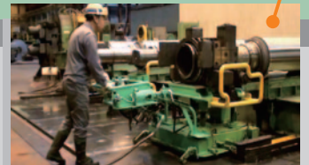
エアベアリングによるロール軸受の着脱
