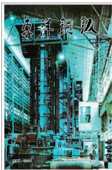
1961年7月下松工場に完成した連続焼鈍炉（速度1500FPM）
