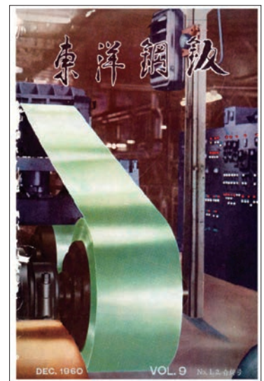
ビニトップ（塩ビ鋼板）製造設備
