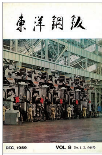
米国 MESTA 社製製品最大巾48" 5スタンド・コールド・ストリップ・ミル
