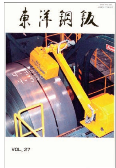
VOL.27 当社で開発したドット・スタンプ方式のマーキング装置
